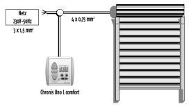
Anschlussleitungen an den Klemmen des Steckrahmens anschließen (Klemmenbelegung siehe Kap. 5.2) und Tragrahmen in U.P.-Dose befestigen. 2.) Chronis Uno L comfort zusammen mit dem Abdeck-rahmen in den Steckrahmen stecken. Dabei nicht auf das Display drücken. Be-triebsspannung anlegen und mit den Tasten "AUF" und "AB" die Laufrichtung prüfen. Bei entgegenge-setztem Lauf, bitte die Drähte an den entsprech-enden Klemmen tauschen. Hierzu muß die Anlage unbedingt spannungslos geschaltet werden!
